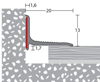
Wandanschlussprofile sind hervorragend geeignet für Balkon-, Terrassentüren sowie bodentiefe Fenster. Das Profil eignet sich für alle Stärken schwimmend verlegter Hartbodenbeläge, da es direkt an der Wand verklebt wird. In schwer zugänglichen Bereichen, zum Beispiel hinter Heizkörpern, kann dieses Profil ebenfalls unkompliziert verlegt werden.
